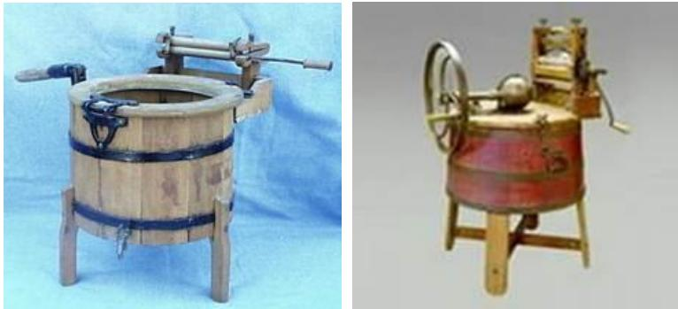
Рисунок 8. Механические стиральные машины
